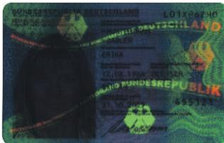
**Mithilfe der DESKO Scanner können Sicherheitsmerkmale unter sichtbarem, Infrarot- und UV-Licht sichtbar gemacht werden.**
